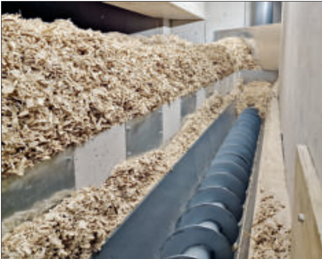
Das getrocknete Biomassematerial wird durch ein Spiralfördersystem, ebenfalls von Steiner, an seinen Einsatzort gebracht.
